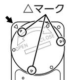
⑤ 電池蓋の○マークが本体右上の○マークの位置に来るまで、電池蓋を本体に押し付けながら矢印の方向に回してください。
