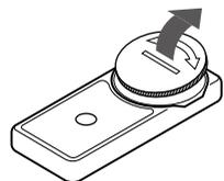
③ コイン形電池(CR2032)と本体の間にある絶縁フィルムを外してください。
