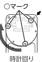
電池蓋が回し辛い場合は、コインなどを電池蓋の溝に差し込み、押し付けながら回してください。
